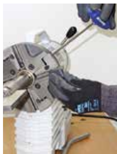
Système de serrage rapide des outils OTC® (Quick-Tool-Change)
