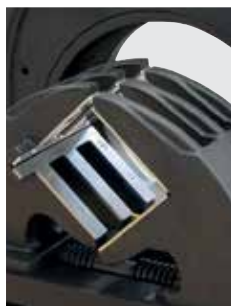
Mors de serrage coulissants en acier équipé de plaquettes de serrage en acier inoxydable
