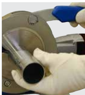
Système de remplacement rapide des outils, des coquilles de serrage et des tubes
