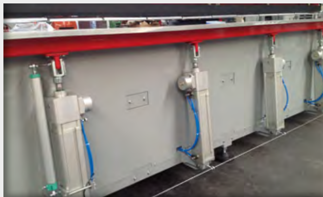
Top picture: Heating element / Lower picture: Bending edge with cylinders Oberes Bild: Heizschwert / Unteres Bild: Biegewange mit Zylinder
